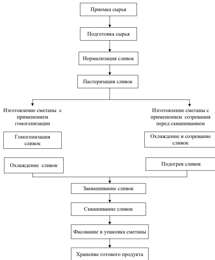
Рисунок 3 – Технологическая схема производства сметаны резервуарным способом
